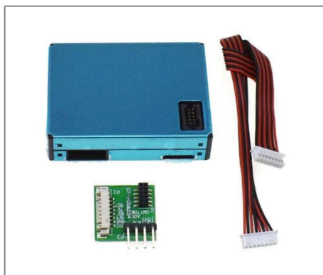
ภาพที่ ก-2 เซ็นเซอร์วัดค่าฝุ่น PM2.5
